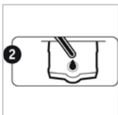
Pipettieren Sie die Probe in die Kartusche.
